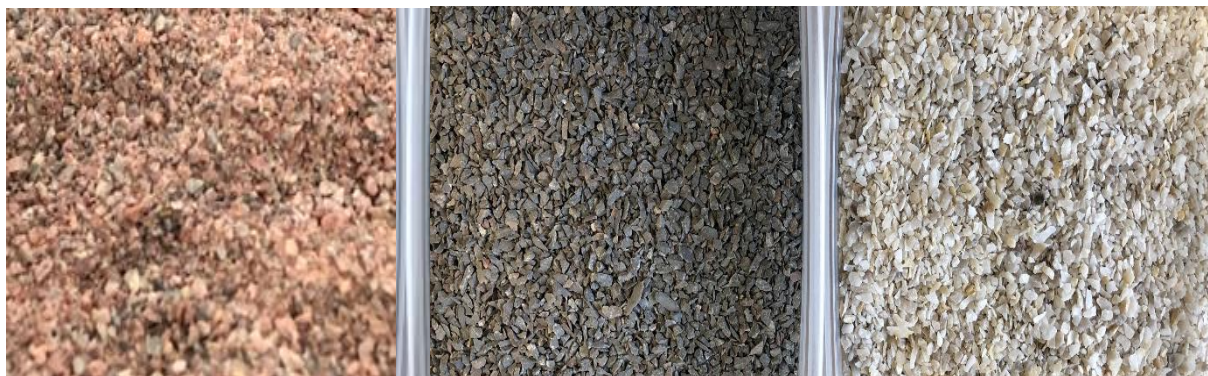
Figur 5.9. Graniten från täkt 1, vänster, hade störst färgpåverkan (längst från origo) och var i mittenspannet avseende ljushet ( L^* ) av analyserade material. Porfyren från täkt 5, mitten, hade minst färgpåverkan (närmast origo) men var samtidigt mörkast (lågt L^* -värde). Kvartsiten från täkt 2, höger, hade bäst L^* -värde och är ljusast men har samtidigt stort färginslag (långt från origo).
