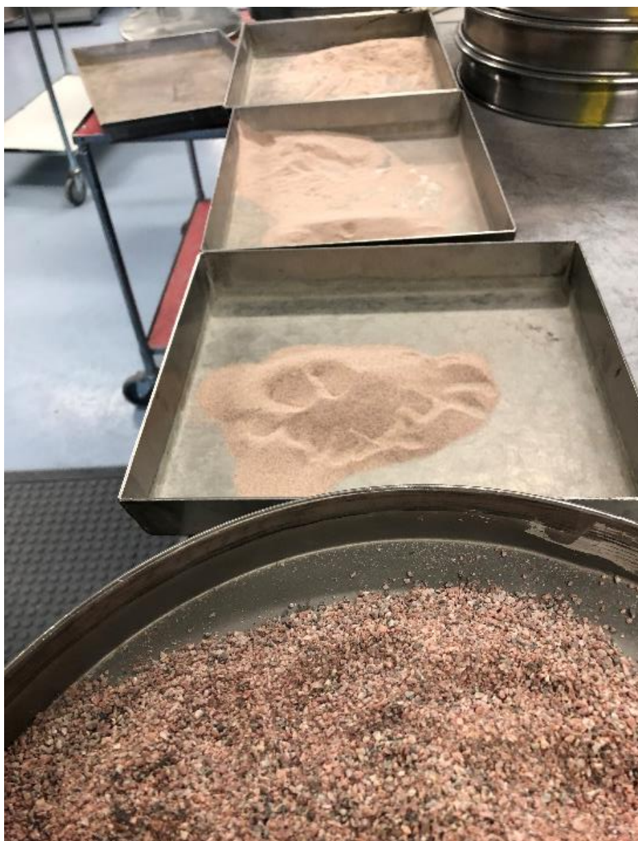
Figur 5.1. Stor ljushetvariation vid olika fraktioner. På denna bild återges samma stenmaterial i olika fraktioner. Fraktionen 1–2 mm närmast i bild följt av 0,25–0,5 mm, 0,063–0,125 mm och <0,063 mm längst bak.
