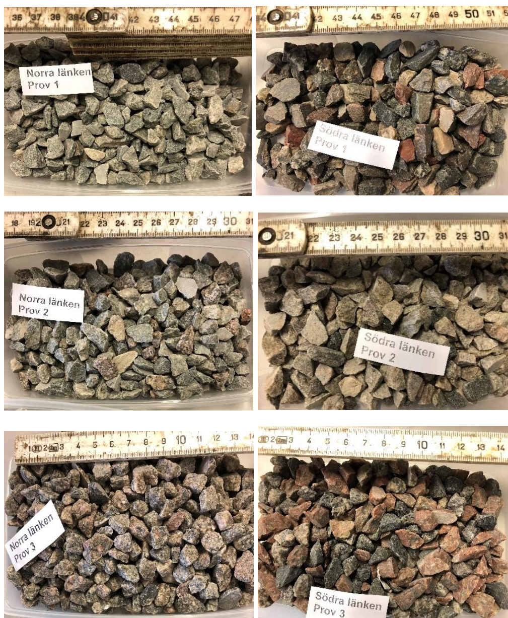
Figur 5.12. Stenmaterial med fraktion 11–16 mm från befintliga vägbeläggningar i Stockholms tunnelnät.
