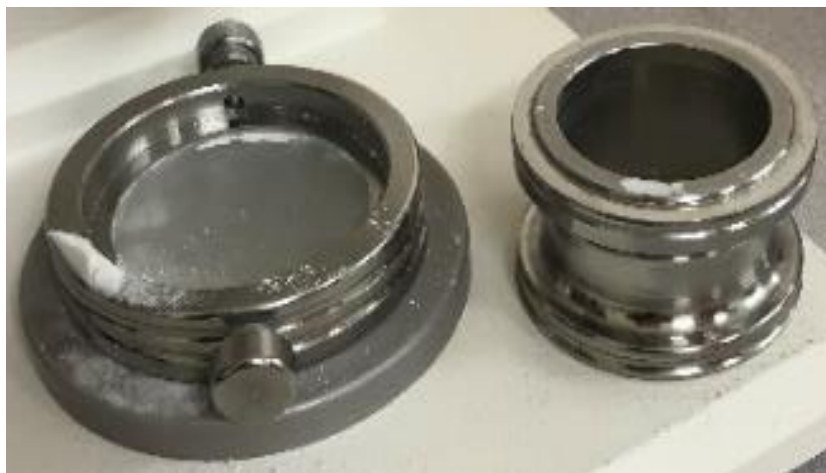
Figur 1.2. Instampningsform för stenmaterial som används vid ljushetsmätningar i laborationsmiljö.
