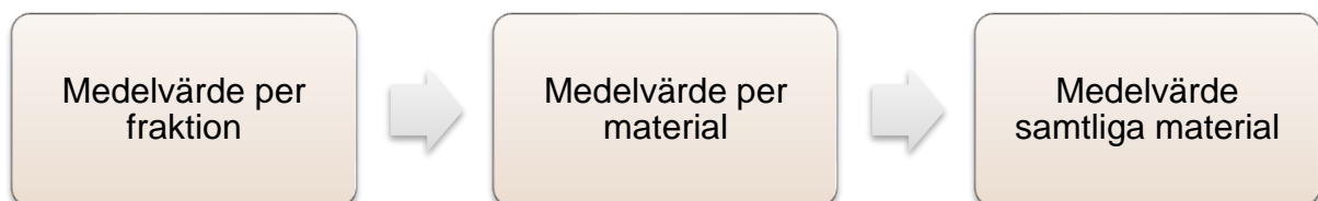
Figur 5.19. Modell för framtagning av ljushetsvärden.
